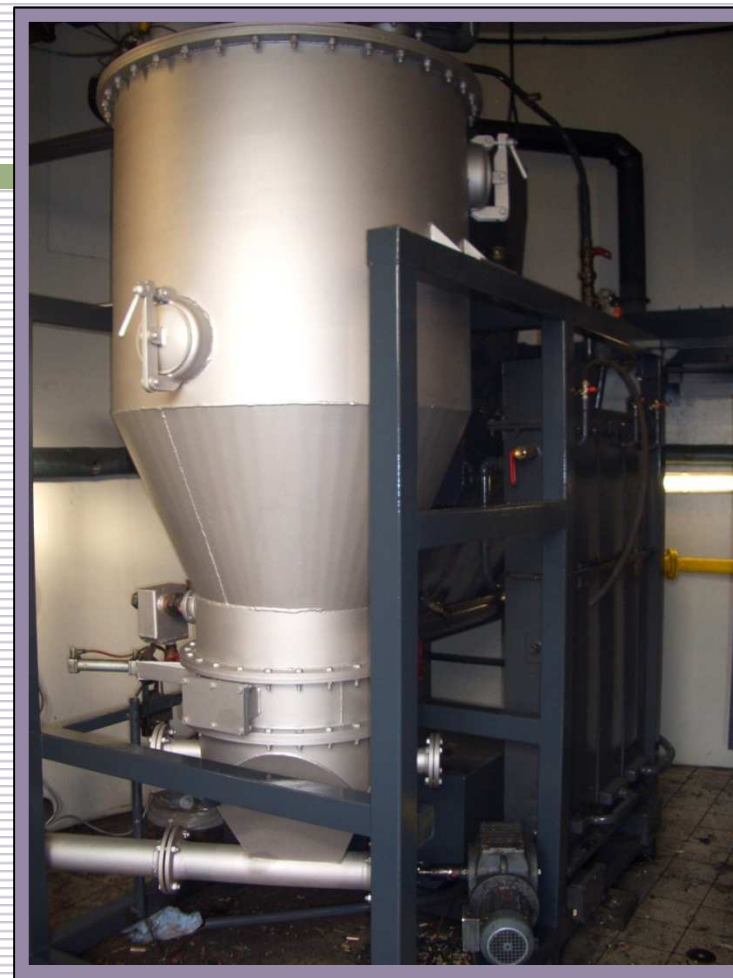
Gassificatore con 4 cilindri motore a gas e carburazione con cuffia di assorbimento sonoro
