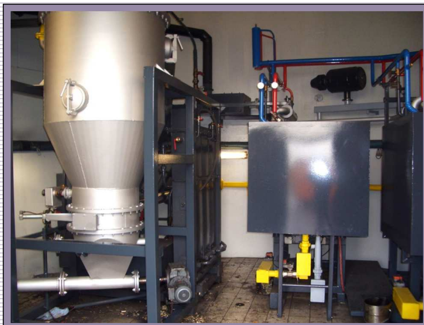
Gassificatore con 4 cilindri motore a gas e carburazione con cuffia di assorbimento sonoro
