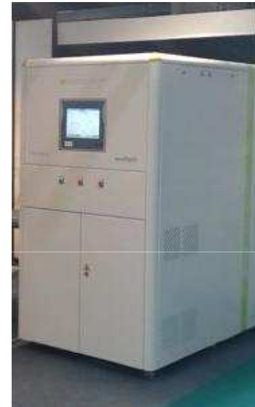
Fig. 4: Micro-turbina ENEFTECH da 30 kW el
