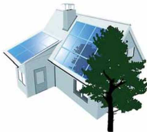
Ombre adiacenti generate da un albero (fonte: www.solarconsult.de )
