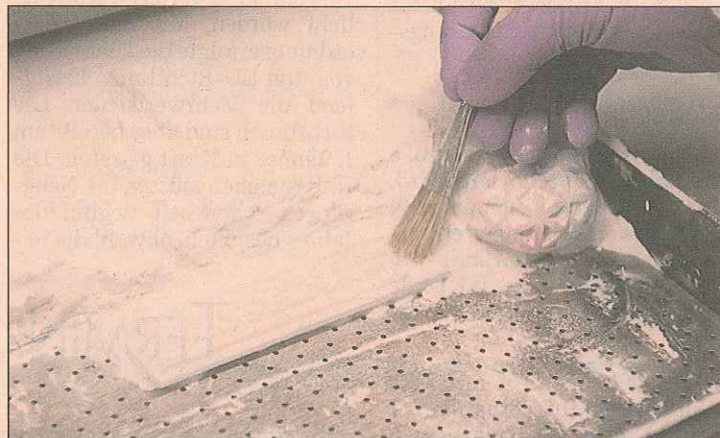
Prototypen werden aus dem Keramikpulver ausgegraben: Innerhalb von Stunden können im Tis nun Modelle hergestellt werden.
